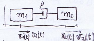
$$\cdot F_1 = K(x_2 - x_1) = -F_2 \quad \text{elasticità molla}$$
